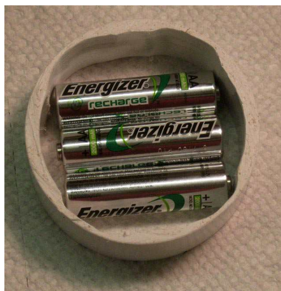
Рисунок 5. Три NiMH аккумуляторных элемента типоразмера AA внутри кольца.
