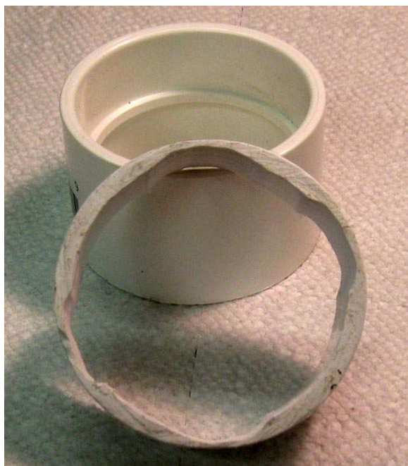
Рисунок 2. Отрежьте кольцо от фитинга трубы из ПВХ.
