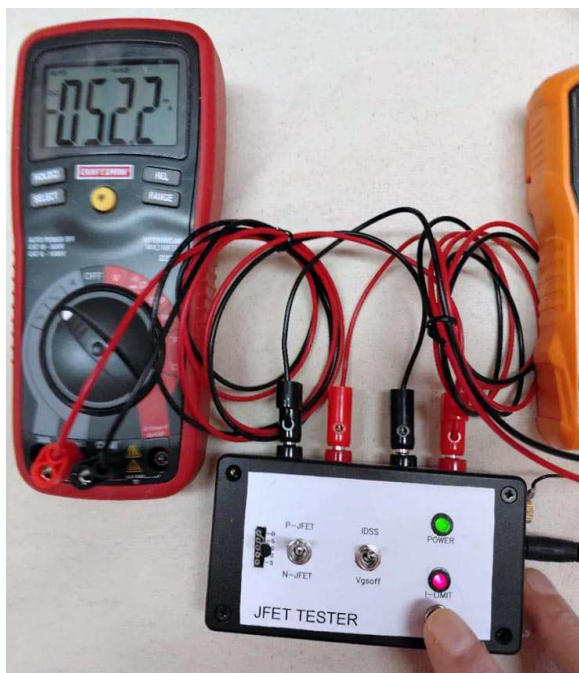
Рисунок 3. Для проверки функции ограничения тока переключатель «n-канал/p-канал» устанавливается в положение «p-канал» для n-канального транзистора MPF102.
