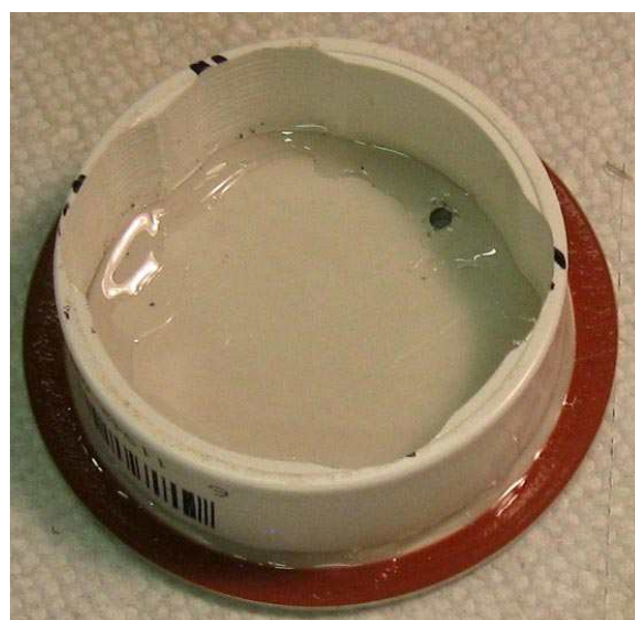
Рисунок 4. Кольцо из ПВХ, приклеенное к крышке банки.
