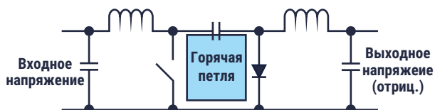
Рисунок 1. Схема топологии Кука для получения отрицательных напряжений.
