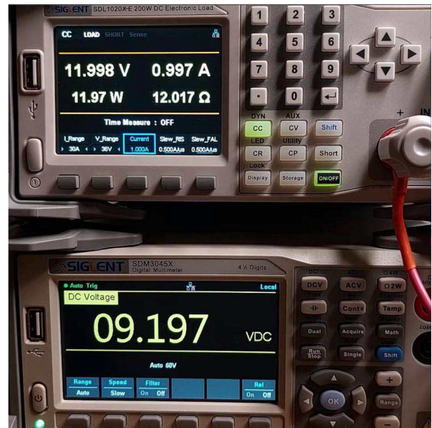
Рисунок 7. Испытания стабильности выходного напряжения и нагрузочной способности в полном диапазоне входных напряжений.
