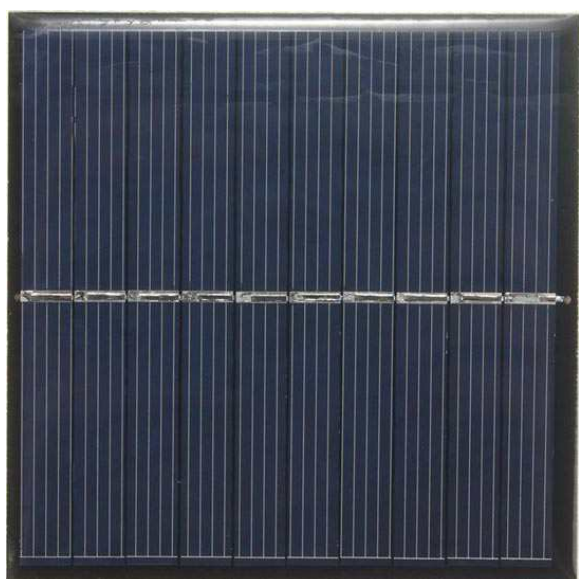
Рисунок 3. 10-элементная солнечная панель 5 В/160 мА.
